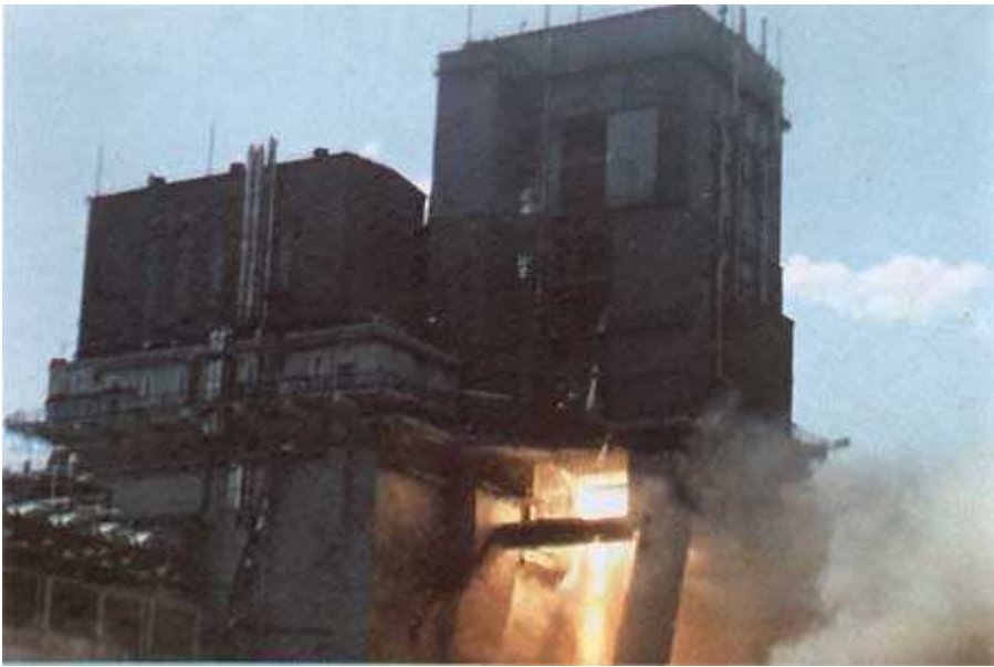
Огневые испытания второй ступени Н1 в НИИХиммаше под Загорском
