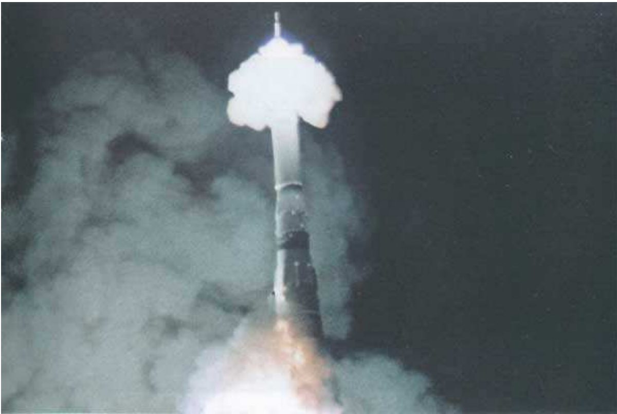
Авария при старте Н1 №5Л. Срабатывает система аварийного спасения
