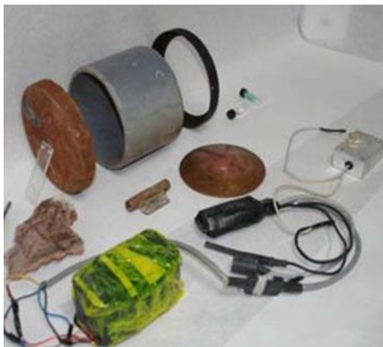
Рис.11. СВУ применяющий эффект ударного ядра (Miznay-Shardin effect) с взрывателем типа PIR(Pyroelectric InfraRed sensor)
