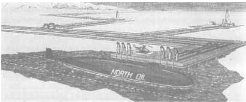
Погрузка нефти на атомный подводный танкер у арктического побережья (по проекту, разработанному в КБ «Малахит»). Длина танкера 238 м, грузоподъемность около 30 тыс. т
