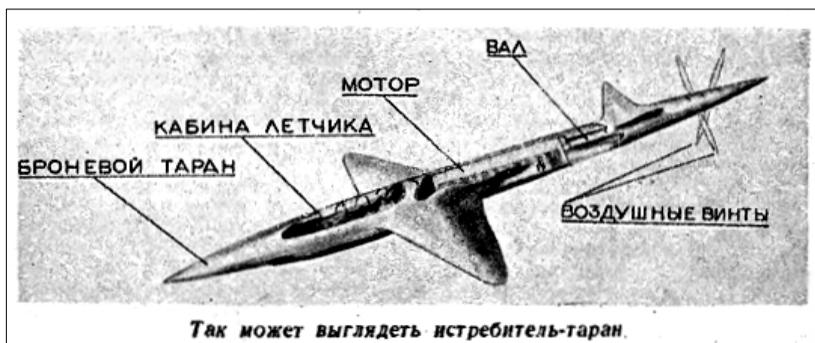
Такая огромная скорость, доходящая до 1 тыс. км в час, может быть получена за счет дальнейшего совершенствования аэродинамики самолета. Суровый «режим экономии» вредных площадей (например, поперечное сечение фюзеляжа), придание всем частям самолета плавных, обтекаемых форм, полностью убирающееся трехколесное шасси, полировка броневой поверхности и пр. — все это позволяет повысить скорость самолета.
