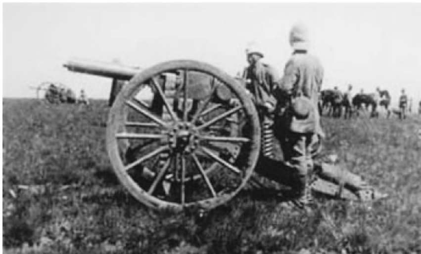
Скорострельное английское орудие Пом-Пом калибра 37 мм. Хорошо видна холщовая патронная лента на 20 снарядов
