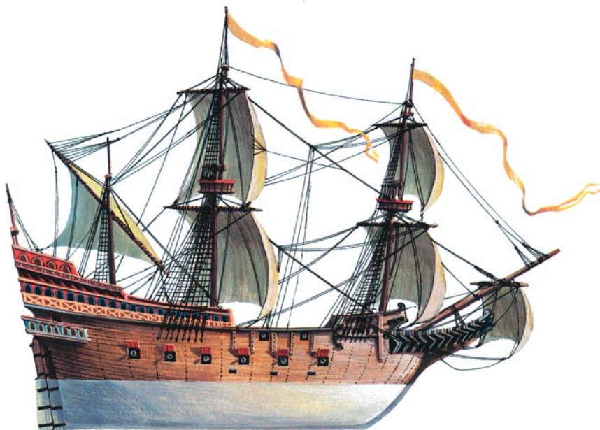
Галеон «Бредерое» (Голландия, 1650 г.) с обычного типа парусами на трех мачтах и блиндом. Судно имело только одну батарею из двенадцати 19-фунтовых орудий, плюс двенадцать небольших пушек на главной палубе. Галеон был флагманским судном Мартена Тромпа, который погиб на его борту во время битвы при Шевенингене против англичан в 1653 г. Размеры: длина — 39 м, ширина по палубе — 5,35 м, водоизмещение — 1112 т, команда — 366 человек
